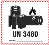
40. Gefahrgut-Kennzeichnung – Transportaufkleber gemäß der Gefahrgutklasse 9A für den sachgerechten Transport von Lithium-Ionen-Batterien einschließlich Lithium-Polymer-Batterien (UN-Nummer 3480).
