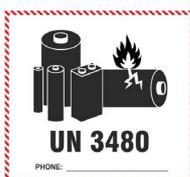
Gefahrgut-Kennzeichnung – Transportaufkleber gemäß der Gefahrgutklasse 9A für den sachgerechten Transport von Lithium-Ionen-Batterien einschließlich Lithium-Polymer-Batterien (UN-Nummer 3480).
