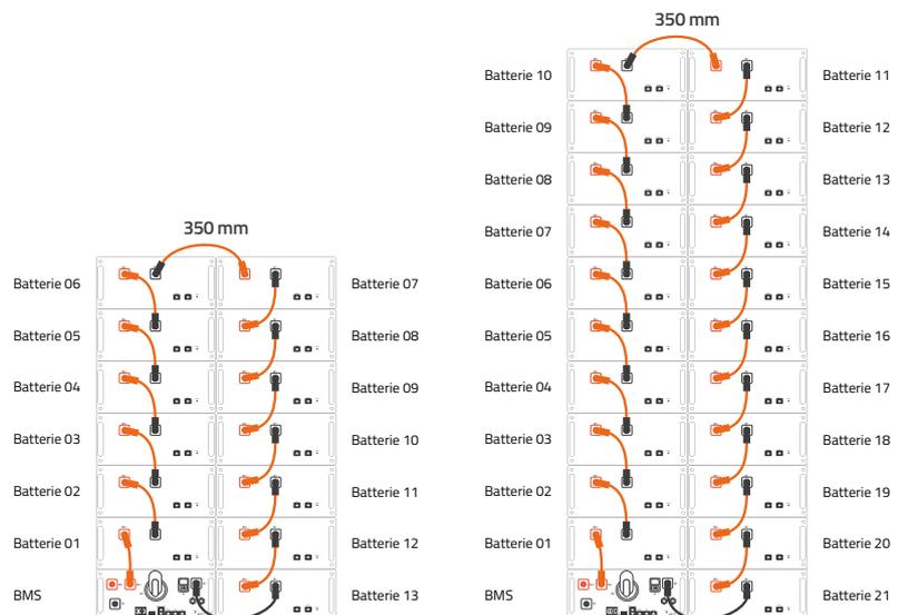
7. Verbinde das BMS und die Batteriemodule mit dem Kommunikationskabel 300mm und dem Kommunikationskabel 750mm, wie in folgender Tabelle dargestellt:
