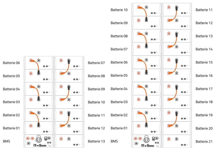
12. Trenne sämtliche Batterie-Zweiergruppen in Einzelmodule auf, indem du die übrigen Kabel 01 (240mm) entfernst. Gib die grauen Schutzabdeckungen unverzüglich auf die freien Anschlüsse.
